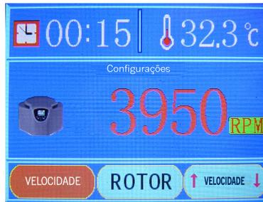
② Pressione o botão “DEFINIÇÃO” para chegar ao painel de ajuste da velocidade de rotação. Em seguida, pressione os botões “PARA CIMA” ou “PARA BAIXO” e pressione novamente o botão “DEFINIÇÃO” para chegar à área de ajuste de tempo. Os minutos necessários podem ser escolhidos pressionando os botões “PARA CIMA” ou “PARA BAIXO”, como mostrado abaixo:
